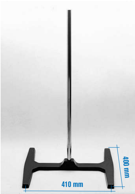
SOPORTE DOBLE T "MAXI" Varilla en acero inox. AISI 304 de 20 Ø x 800 mm alto. Para soportar pesos hasta 20 Kg a unos 300 mm de la base. Gran estabilidad. Útil para soporte de agitadores. Peso: 7 Kg. Código 6000410
