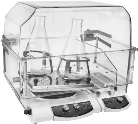
Incubator-1000 configurado con módulo calefactor y campana XL + agitador Polymax 1040
