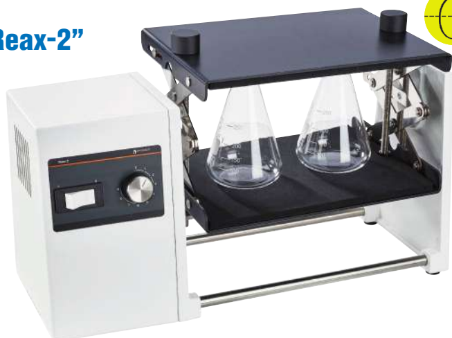
Agitador REAX-2 con adaptador Universal incluido.
