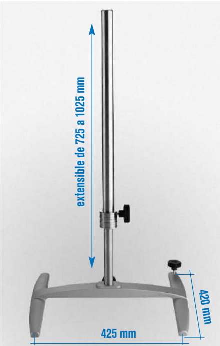
SOPORTE DOBLE T TELESCÓPICO Varilla en acero inox. AISI 304 de 32 mm Ø. Altura de elevación desde 725 a 1025 mm. Para soportar pesos hasta 20 kg. Peso: 7,7 Kg. Compatible con la nuez código 5057022 (ver pág. 224). Código 5057011
